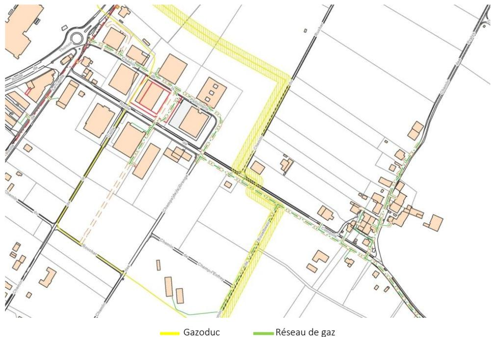
FIGURE 10 : RÉSEAU DE GAZ ET GAZODUC - PALLANTERIE ET ESSERT
